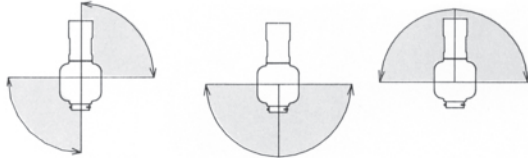
360° 全角噴射 下180° 噴射 上180° 噴射
